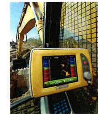
■オペレーターはモニターに表示される設計とバケット位置(高さや勾配)の差を常に確認しながら作業が可能
