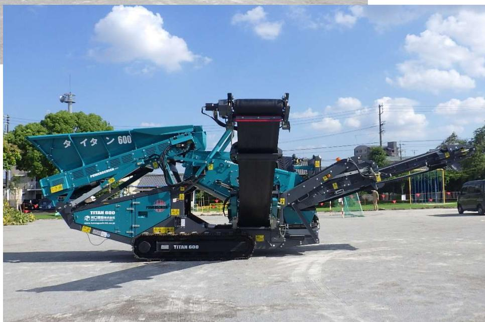
河口建設(株) (愛知県春日井市/企業組合員) が、現地の土を再利用し土壌改良を迅速に行うために、処理能力の高い高性度篩いわけ機 (自走式選別機・タイタン 600 トラック) を新規導入されました。
