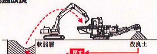
固化材添加量の調整で、任意の強度の地盤改良が可能。
